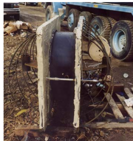
O-Cell 用于侧面岩石模量测试
